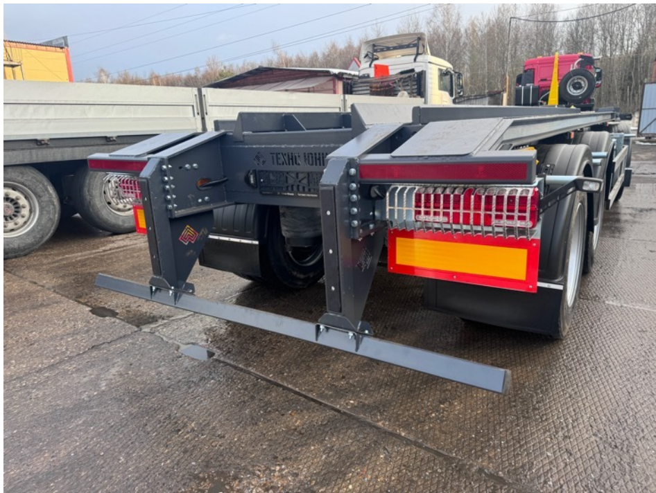
Задние фонари установлены в защитных кожухах
