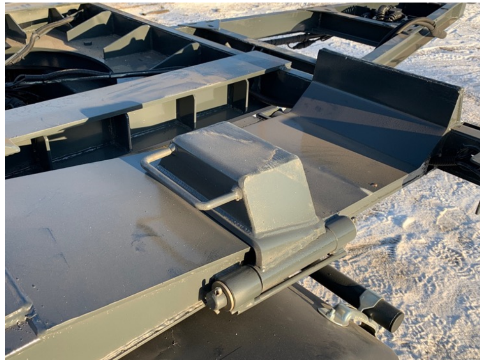
Дополнительные противооткатные упоры бункера
