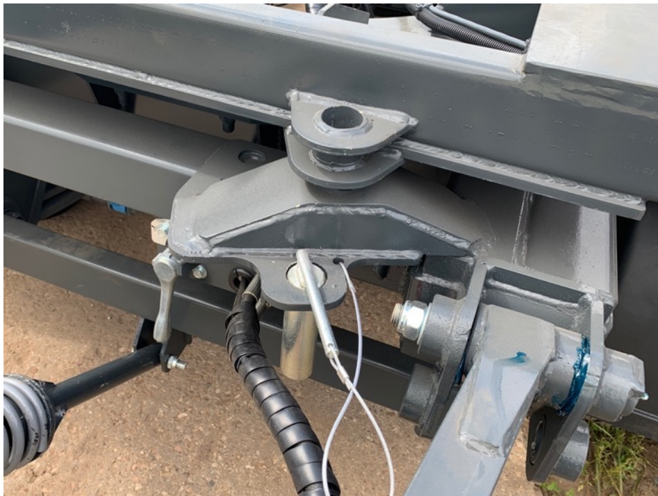
Усиленный стопор поворотного круга
